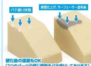
硬化後の塗装もOK (2つのパーツの同じ箇所をパテ盛りしてあります)
