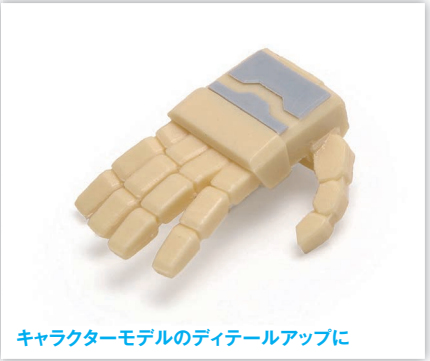
打ち抜いたプラ板の間に、短冊状にカットしたプラ板を合わせて
